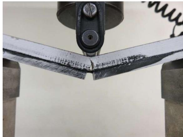
Figura 5. Montaje para la realización del ensayo de flexión en tres puntos en una máquina de ensayos universales. Panel híbrido constituido por una lámina de porcelánico, adhesivo poliuretano y una lámina de pladur.
