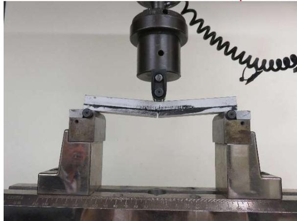
Figura 4. Montaje para la realización del ensayo de flexión en tres puntos en una máquina de ensayos universales. Panel híbrido constituido por una lámina de porcelánico, adhesivo poliuretano y una lámina de pladur.
