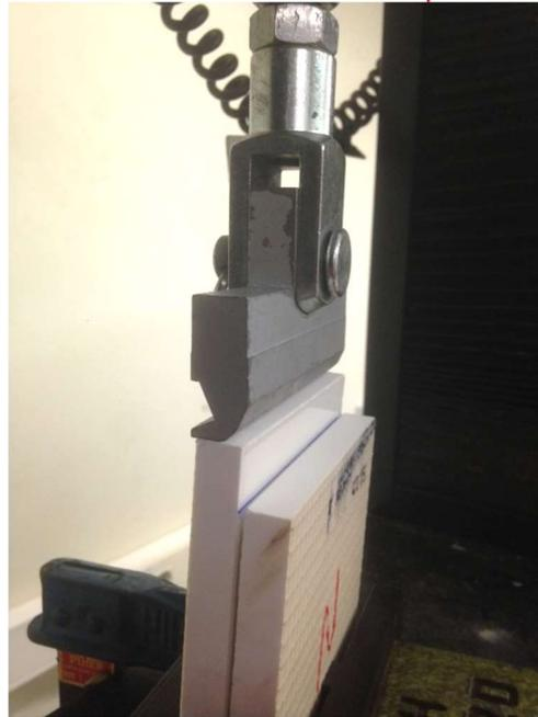
Figura 1. Montaje de las probetas en el soporte de ensayo a la cizalla de la máquina de ensayos universales.
