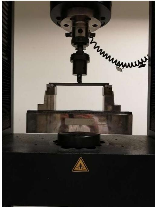
Figura 3. Montaje para la realización del ensayo de flexión en tres puntos en una máquina de ensayos universales.
